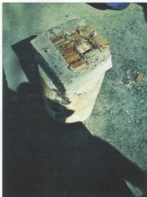
Bloques de cemento que contenían pilas
